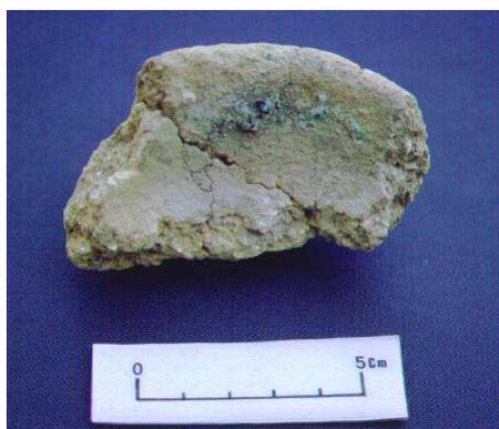
Figura 1 – Cadinho com restos de escória e metal agarrados.
