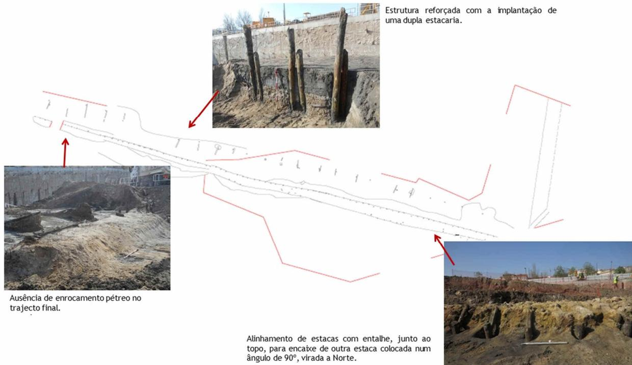
Figura 5 – Particularidades identificadas na tipologia construtiva do quebra-mar.
