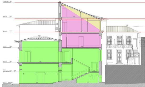
Figura 32 – Corte transversal onde se representam as várias fases construtivas (fase I a verde, fase II a rosa, fase III a castanho).
