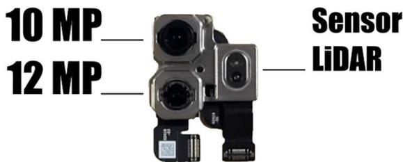
Figura 1 – Sensor LiDAR presente nos dispositivos da Apple.
