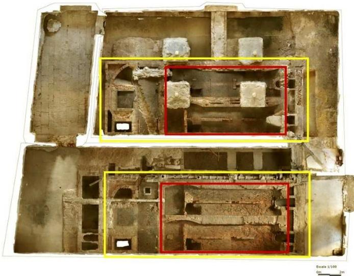
Figura 10 – Levantamento fotogramétrico da Casa das Caldeiras, observando-se os dois compartimentos paralelos para cada uma das baterias de caldeiras, (a amarelo), com suas áreas centrais onde se instalavam as caldeiras, (a vermelho), e suas restantes áreas anexas.
