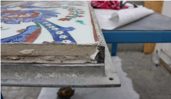
Figura 5 – Vista lateral de um painel após a remoção parcial da moldura metálica, evidenciando a espessura e a rigidez do sistema de montagem.
