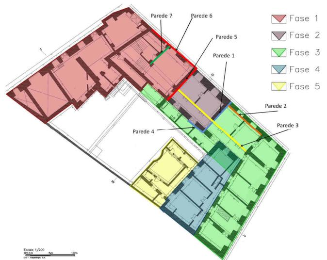
Figura 10 – Planta do edifício existente previamente à obra e seu faseamento construtivo.
